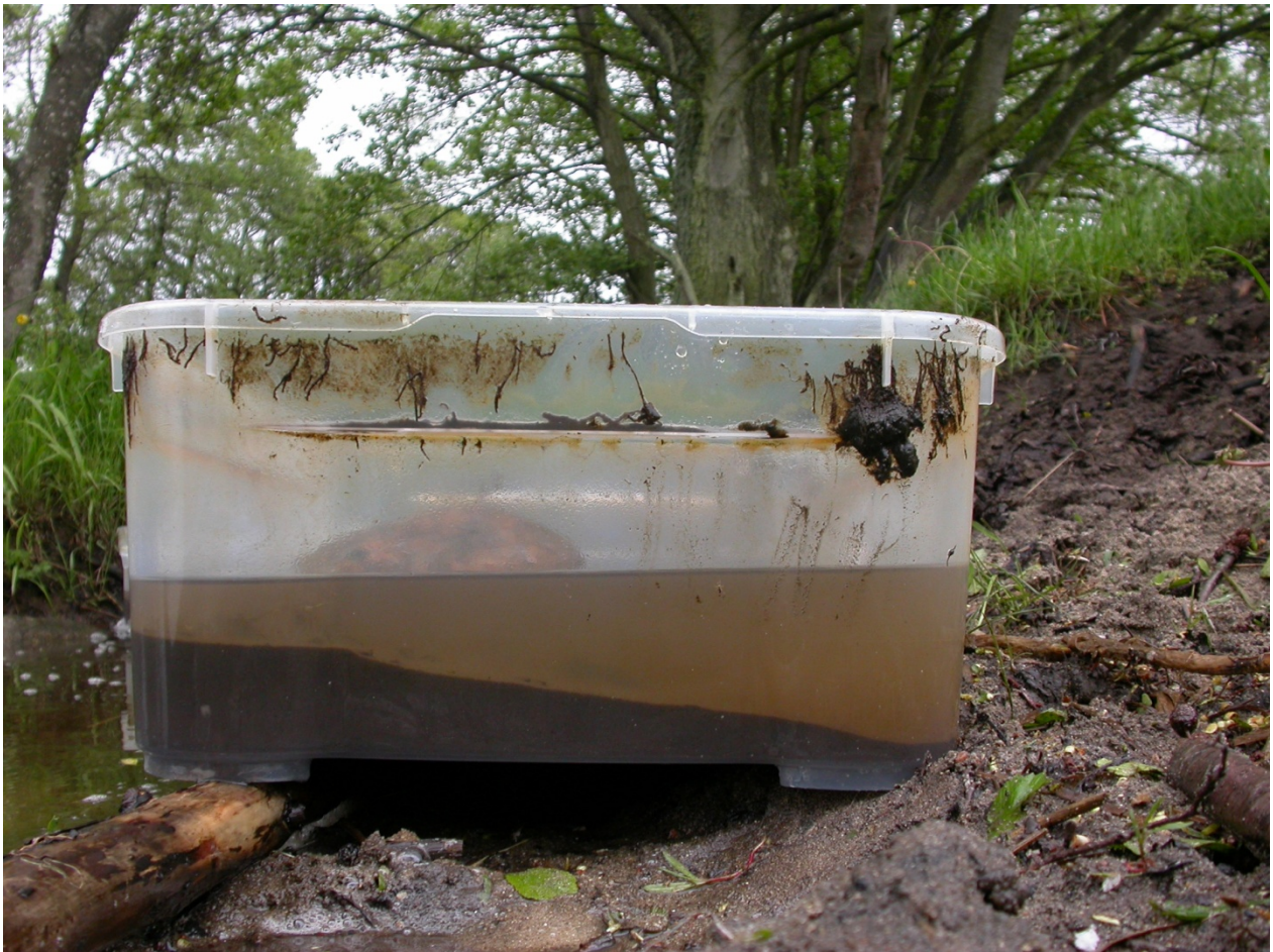
Figur 30. Plastback som legat nedgrävd med sin övre kant i linje med botten i Graften i Helge ås gamla åfåra i syfte att samla upp bottenvandrande sediment. Att sedimentet är koncentrerat till vänstra sidan av backen beror på att vattnet dekanterats åt det hållet, i verkligheten konstaterades ingen koncentration till endera sidan av backen. Stenen som skymtar i borte delen av backen användes som tyngd för att backen inte skulle röra sig under den vecka försöket pågick. Graften 2010-06-01. Foto: Olof Jönsson.
